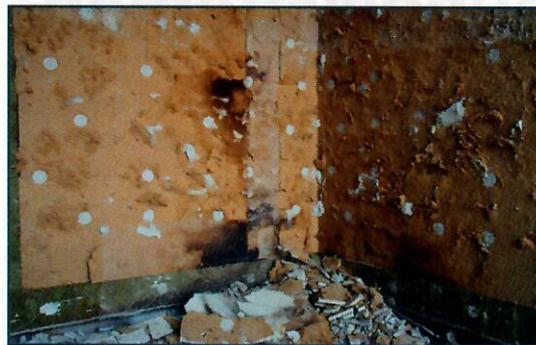
**Abbildung 2:** Dämmstoffoberfläche nach Abtrag der Putzschicht nach einem Sockelbrandversuch (ca. 2,4 MW) an der MFPA Leipzig [1, 3].
